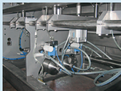
Forma modellata con componenti pneumatici Festo.
