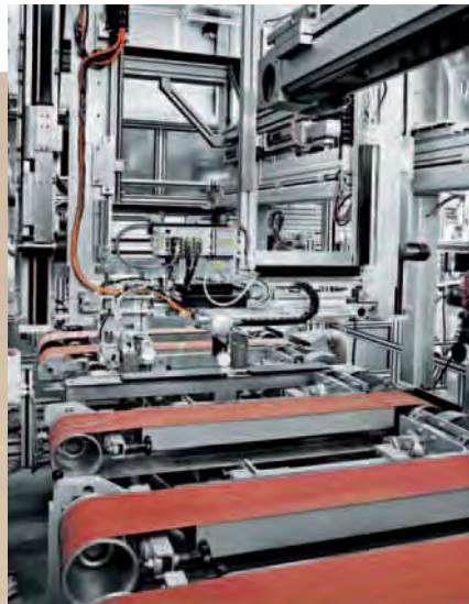
Au poste de ponçage , les touches sont amenées au bon rayon de 502 mm à 1200 mm.
