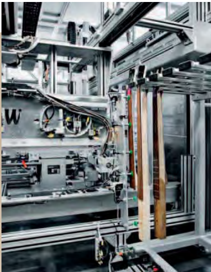
Au début, le bois brut : des ventouses saisissent les délicates touches, le module rotateur électrique ERMB faisant basculer le manche à l'horizontale.
