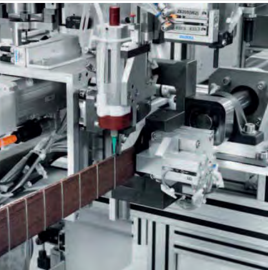
Hermétiquement scellées : après rotation de 90° des manches, la machine scelle les rainures contenant les frettes.
