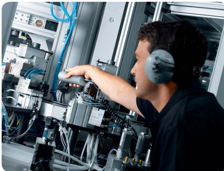
Kontrola wycieku układu pneumatycznego
