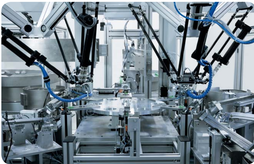
Urządzenie do automatycznego montażu wyposażone w manipulatory Tripod EXPT.
