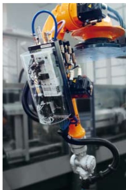
► Ilustracja 2: Elastyczność jest atutem: montaż systemów CPX bezpośrednio na maszynach upraszcza montaż i zwiększa wydajność
