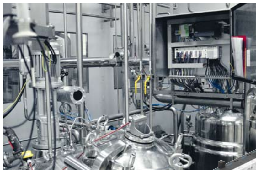
▲ Ilustracja 1: Najwyższy stopień integracji funkcji: dzięki systemom CPX sterowanie ruchem, a także bezpieczeństwo i diagnostyka są możliwe do wdrożenia również w automatyzacji fabryk – tak jak w przypadku tej szafy sterowniczej dla instalacji farmaceutycznej
