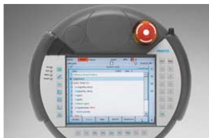
Panel operatorski CDSA. Programowanie w języku Festo Teach Language (FTL)
