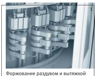
Формование раздувом и вытяжкой
