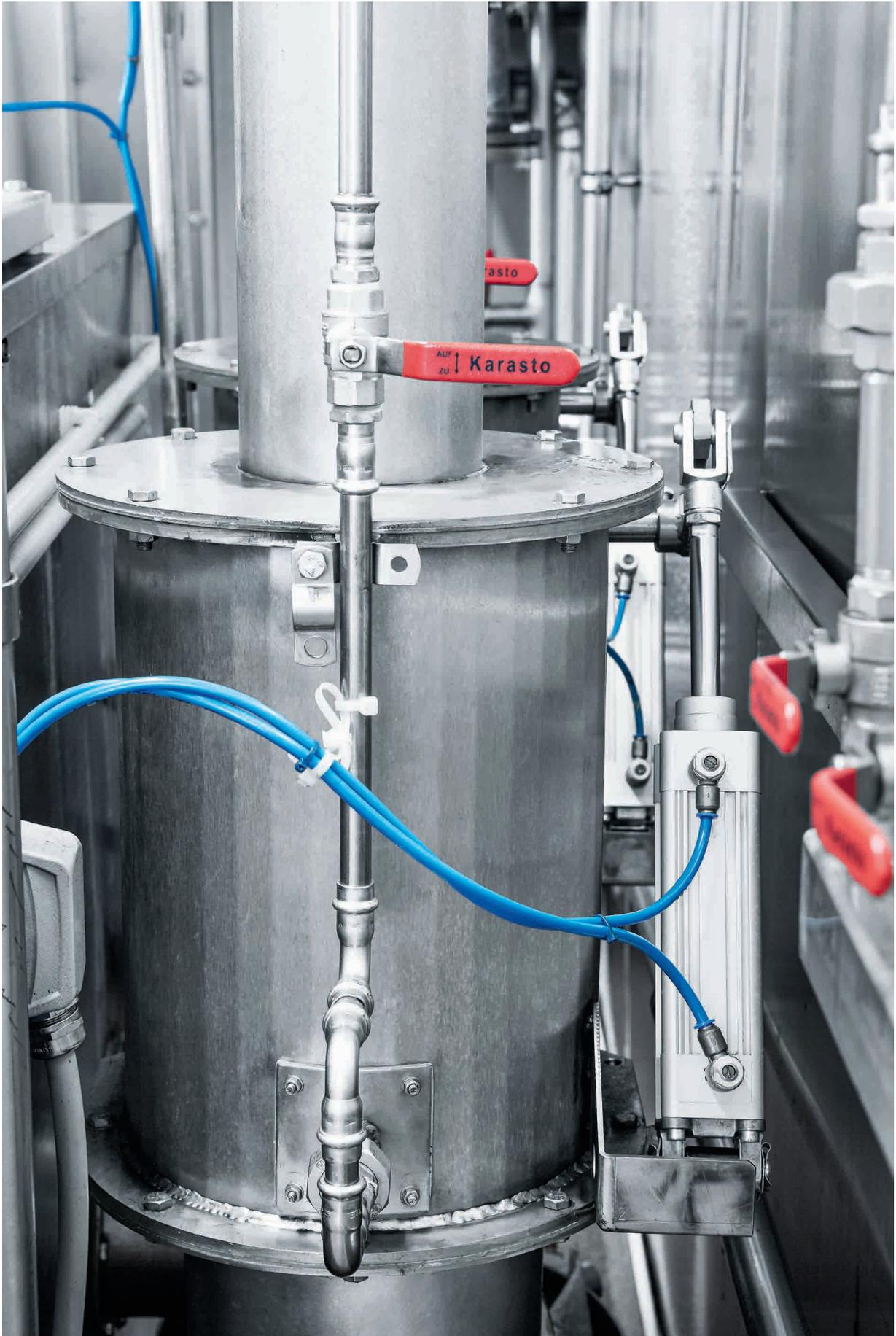
Los cilindros normalizados DSBC con amortiguación neumática autorregulada PPS controlan las mariposas del vapor caliente entre el generador de humo y el ahumador.
