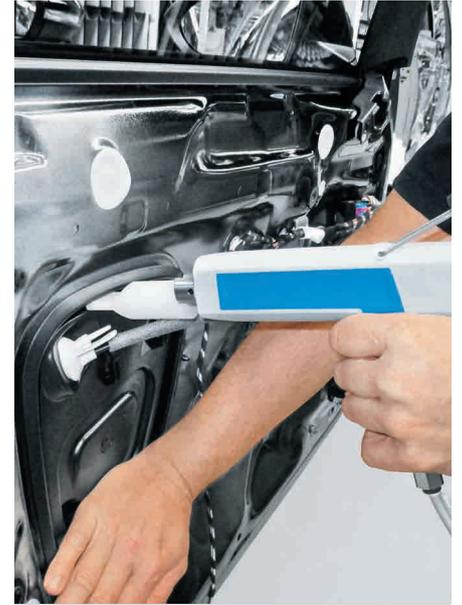
Facilita el montaje de automóviles: el dispositivo para fijación con clips evita la sobrecarga ergonómica de las articulaciones de los dedos y de las muñecas.
