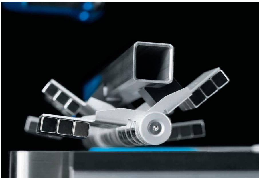
Para sujetar un objeto, las bobinas eléctricas que se encuentran encima de los criostatos emiten un impulso. Según sea el caso, este impulso interrumpe la conexión con los dos elementos de sujeción magnéticos, o bien vuelve a establecerla. Debido a este impulso, los dedos se mueven hacia abajo o hacia arriba, por lo que las pinzas se abren o cierran.
