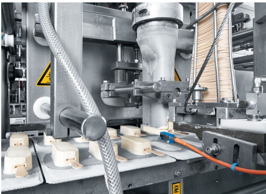
Perfect geportioneerd: De kernstukken verlaten in luttele seconden de extruder in de Magnum-productie. Het ijs wordt al bij het extruderen voorzien van de steel.
