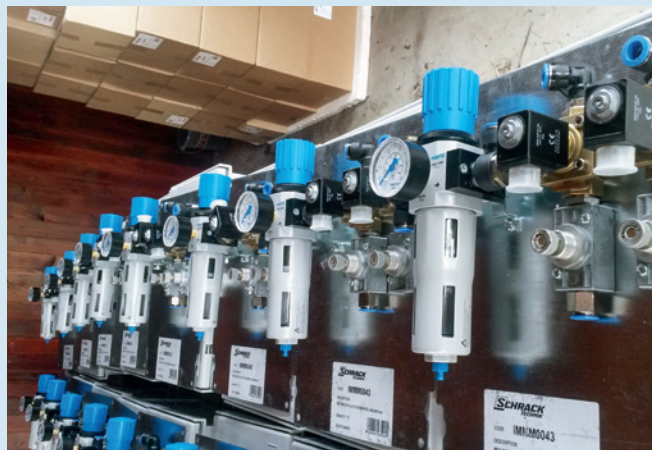
Magneetventielen VZWF: Achter de coulissen zorgen zij voor veiligheid bij zijwind.
