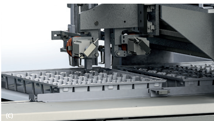
(A) Machine voor het laden aan de uitgang van de blistermachine (B) Machine voor het lossen aan de ingang van de kartonneermachine (C) Een lader laat de blisters vallen in de uitsparingen van de houders
