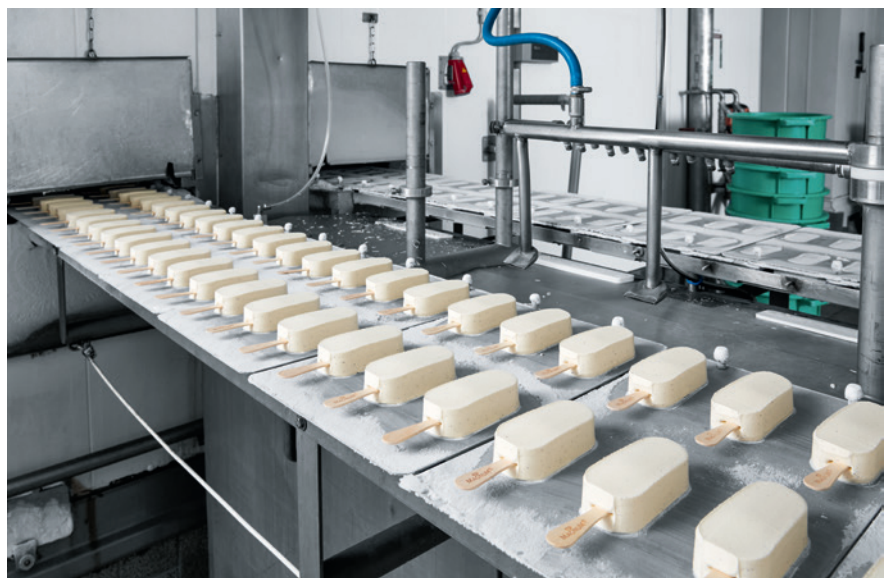
Aan de lopende band: Een van de vijf Magnum-installaties produceert meer dan 20.000 stuks per uur.
