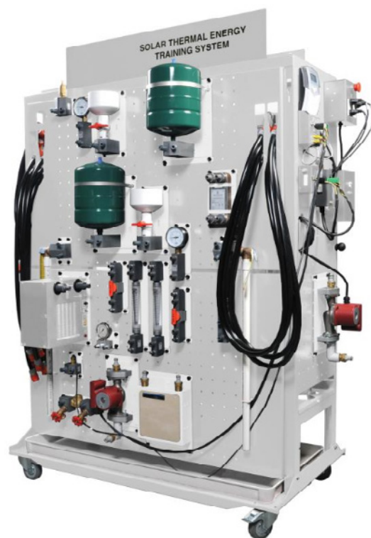
Opleidingssysteem voor thermische zonne-energie.
