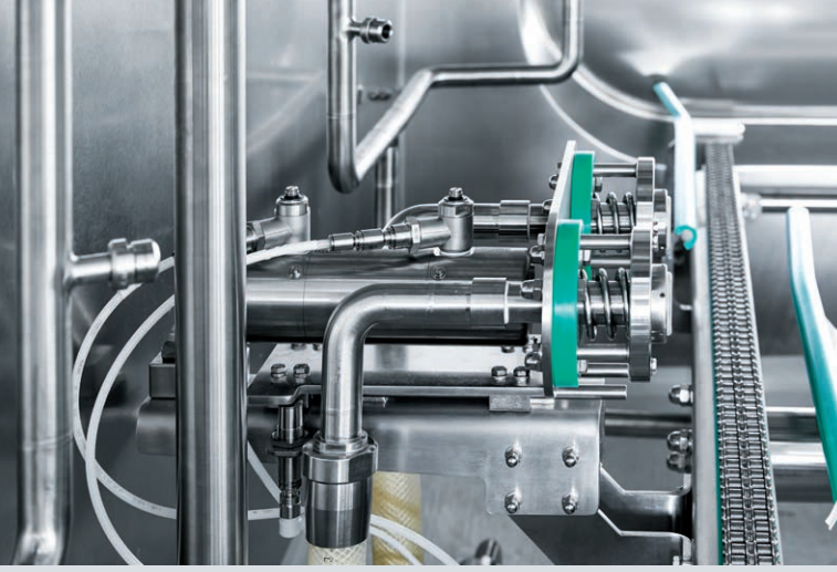
Tanklar , bir yaylı rakor, paslanmaz çelik silindir CRHD ve tek yönlü debi kontrol valfi CRGRLA'dan oluşan özel bir aygıt kullanılarak kilitlenir.
