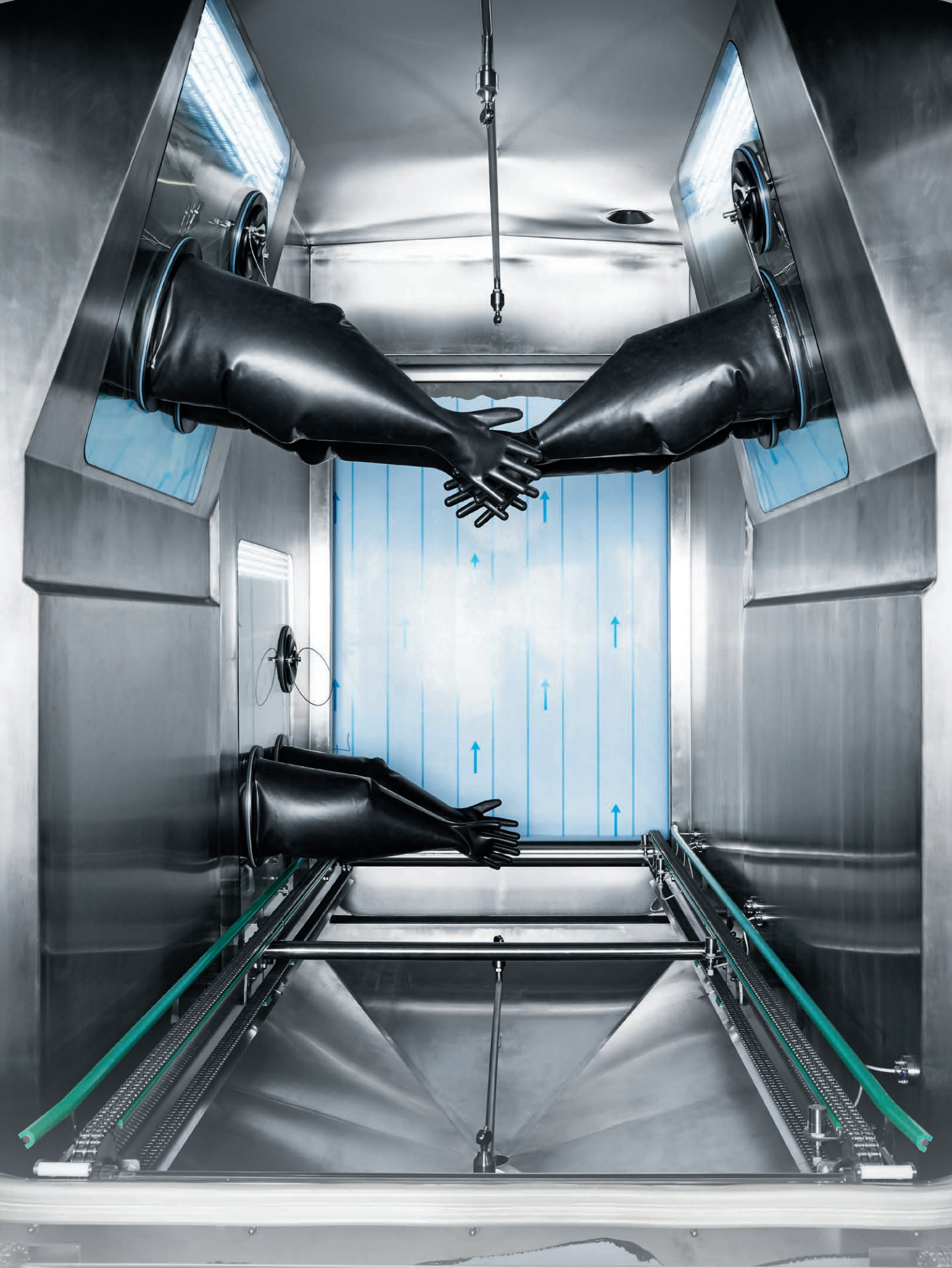
Güvenilir temizleme: Lasetik eldiven kullanarak tankları açmak için güvenlik kabini.
