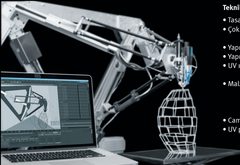
Dijital üretim: yazılım, üretilmesi istenen şeklin geometrisini doğrudan paralel kinematik sistemin hareket alanına transfer eder.
