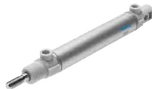
Attraktiv im Preis – Die neue Rundzylinderfamilie nach ISO 6432 mit Aluminiumrohr und Polymer-Deckeln. Verfügbar in den Baugrößen 16/20/25 mit Schwenkbefestigung im Abschlussdeckel. Bestens geeignet für einfache Automatisierungsaufgaben wie Weichen- und Klappensteuerungen oder auch einfache Klemm- und Haltefunktionen.
