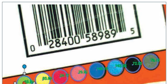
Bestimmt die Farbe der Pixel entsprechend RGB-, HSV- und YUV- Farbraum in einem frei definierbaren Bereich des Bildes
