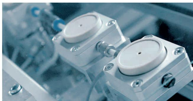
Praktisch berührungslos werden die Glassubstrate auf Luftlagern, die zu kundenspezifischen Rails montiert werden können, transportiert
