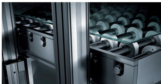
Pneumatische und elektrische Antriebe werden bei Liftersystemen von Festo geschickt kombiniert und sorgen so für eine sanfte Positionierung des Glases
