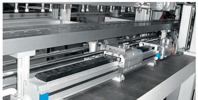
Die Zahnriemenachse EGC mit sinusförmigen Beschleunigungsrampen sorgt für ruckfreie Bewegung beim Aufgreifen der Strings
