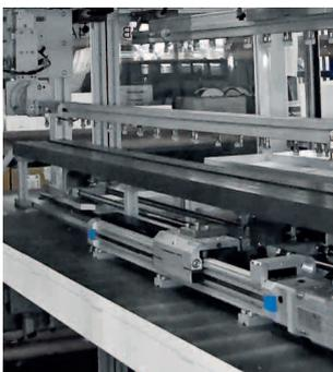
Ein elektrisches Linienportal positioniert die Strings so sanft wie möglich, um Zellbruch zu vermeiden
