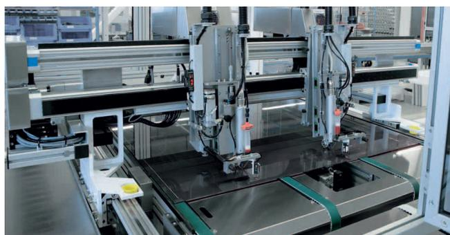
Dos cabezales dispensadores que trabajan en paralelo y se pueden posicionar con independencia uno del otro se encargan de aplicar las tiras de adhesivo sobre la célula de capa fina
