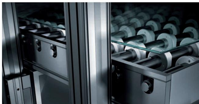
En sus sistemas elevadores, Festo combina hábilmente accionamientos neumáticos y eléctricos que permiten posicionar el vidrio con suavidad
