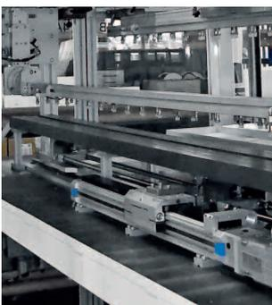
Un pórtico eléctrico con un eje de movimiento posiciona las hileras con la máxima suavidad posible para evitar que se rompan las células
