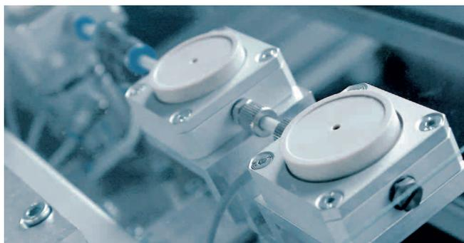
Los sustratos de vidrio se transportan, prácticamente sin contacto, sobre unos colchones neumáticos que se montan sobre carriles específicamente diseñados para la aplicación del cliente
