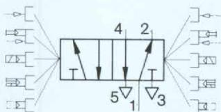
Das Festo Cassettenventil ist ein 5/2-Wegeventil mit robuster, überschneidungsfrei arbeitender Flachschieber-Konstruktion und verstärktem Doppel-Membranantrieb mit Schnappeffekt. Die Gleitpaarung des Flachschiebers ist selbstnachstellend.
