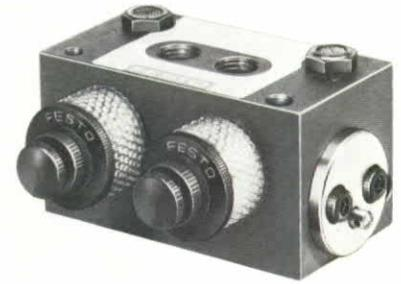
Die Umsteuerung des Ventils erfolgt wahlweise von Hand durch Schalthebel, mechanisch über Schaltstößel durch Betätigung der eingebauten 3/2-Wegeventile oder pneumatisch durch Signal auf Anschluß Y oder Z. Die Geschwindigkeit von Vor- und Rücklauf eines Zylinders wird durch Abluftdrosselung an den beiden Reglerschrauben eingestellt.
