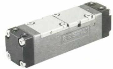
Das Ventil wird durch wechselseitige pneumatische Signale auf Anschluß 14 und 12 umgesteuert. Die Schaltstellung bleibt nach Wegnahme des Signals, bis zum Gegensignal, erhalten.
