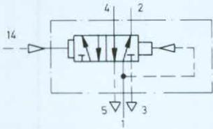
Nur für die Dauer der Signalgabe auf Anschluß 14 wird das Ventil umgesteuert. Die Rückstellung erfolgt pneumatisch aufgrund verschieden großer Wirkflächen der beiden Steuermembranen (Luftfeder).
