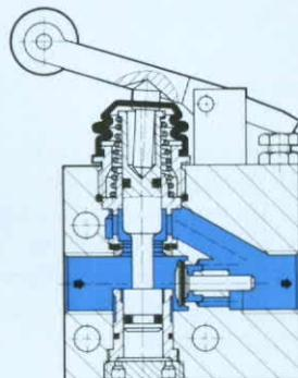
Unabhängig von der Vorsteuerung und Hebelstellung ist in umgekehrter Durchflußrichtung (gegen Pfeilrichtung) der volle Querschnitt frei.
