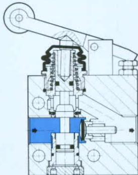
Bei Typ GGO wird durch Betätigung des Rollenhebels der Durchflußquerschnitt gedrosselt bzw. geschlossen.
