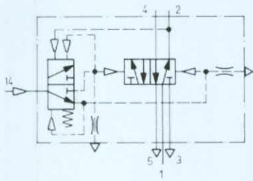
Das Ventil besteht aus einem 5/2-Wege-Grundventil mit angebautem Unter-setzer-Element. Ein Signal bei Anschluß 14 schaltet das Ventil um und sperrt den Unter-setzerkolben. Nach Signalende wird der Unter-setzerkolben durch eine Feder bzw. über Ausgang 2 so umge-steuert, daß das nächste Steuersignal das Zurückschalten des Ventils bewirkt. Bis zu dessen Eintreffen behält das Grundventil seine Schaltstellung bei. Das bedeutet, bei jedem Signal auf 14 wechselt das Ausgangssignal bei 4 und 2.
