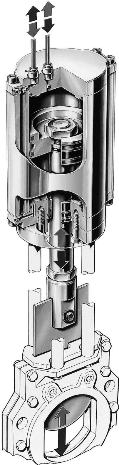
Für den freien Durchgang oder zur Unterbrechung von Stoffströmen werden in Rohrsystemen die entsprechenden Absperrschieber eingesetzt. Diese gibt es in den unterschiedlichen Nennweiten von DN 50 bis zu DN 600, standardmäßig.
