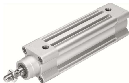
Selbsteinstellende Luftdämpfung: Der Normzylinder DSBC-PPS von Festo stellt sich automatisch ein und kommt so ohne Einstellschraube aus.
