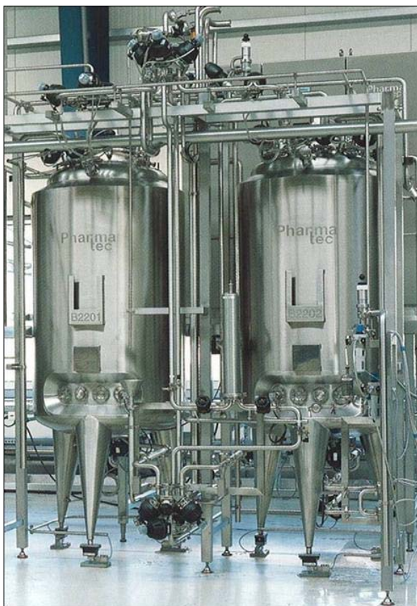
Fig. 11: Sistema para la preparación de mezclas en una planta de la industria farmacéutica.
