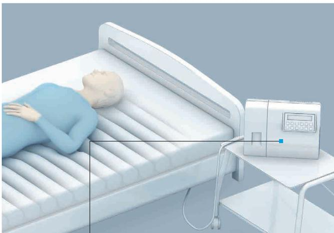
Las cámaras se controlan mediante válvulas piezoeléctricas. Con un ruido de funcionamiento casi inapreciable, su comportamiento proporcional con arranque suave garantiza un cambio de presión respetuoso y silencioso.
