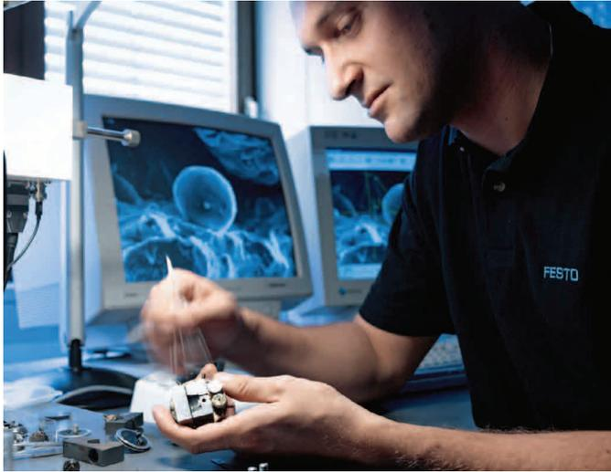
Abb. 8 Einsatz eines Elektronenmikroskops für die genaue Analyse beschädigter Lager
