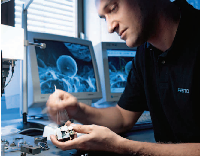
Fig. 8 Microscopios electrónicos utilizados para realizar un análisis detallado de los cojinetes dañados
