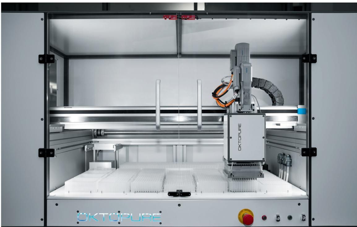
Den hohen Automatisierungsgrad ermöglicht ein Handhabungssystem von Festo, das Experten des Herstellers pneumatischer und elektrischer Automatisierungstechnik individuell auf die Anforderungen der Laboranwendung angepasst haben.
