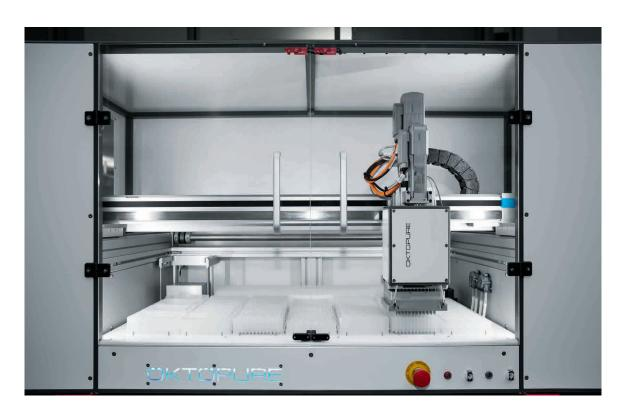
El elevado grado de automatización se explica gracias al sistema de manipulación de Festo. Los expertos de Festo, especializados en técnicas de automatización neumática y eléctrica adaptaron el sistema de manipulación específicamente a las exigencias que plantea su utilización en laboratorios.
