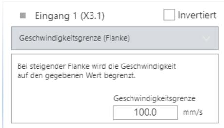
Bild 5.3: Konfiguration „Geschwindigkeitsgrenze (Flankengesteuert)“
