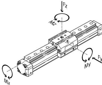
Wirken gleichzeitig mehrere der unten genannten Kräfte und Momente auf den Antrieb ein, müssen neben den aufgeführten Maximalbelastungen folgende Gleichungen erfüllt werden:
