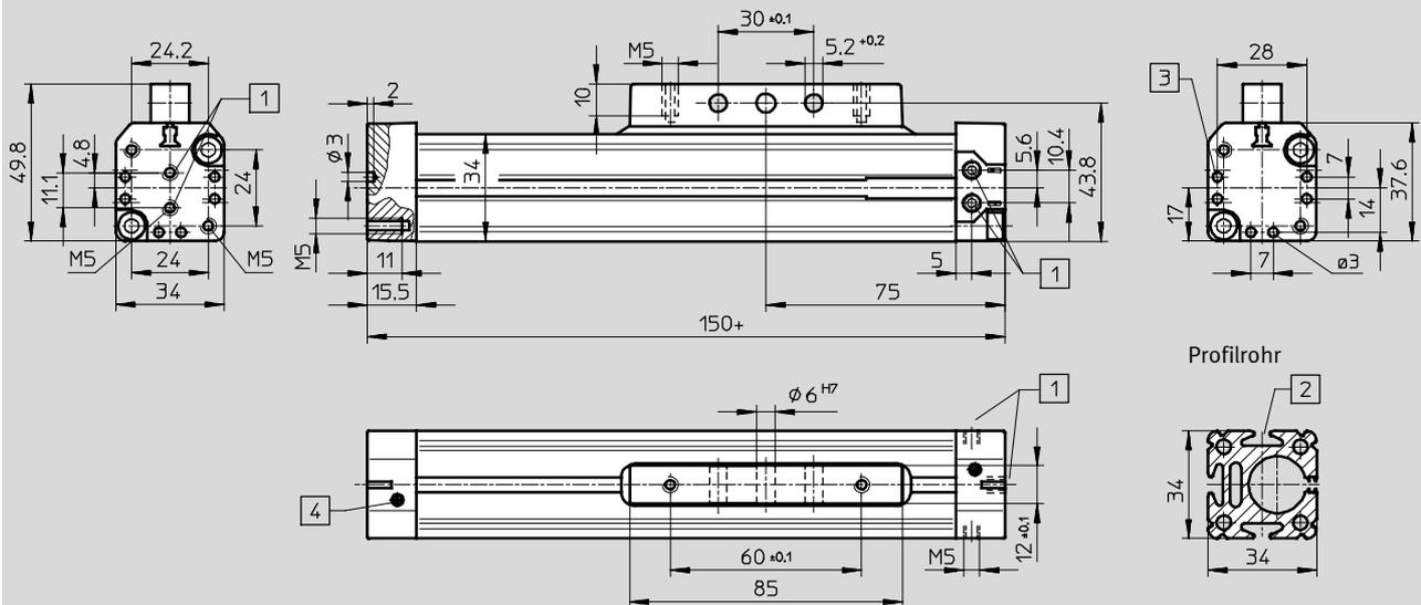
1 Einseitiger Druckluftanschluss, wahlweise an 3 Seiten an einem Abschlussdeckel (Variante D2: beidseitiger Druckluftanschluss, wahlweise an 3 Seiten pro Abschlussdeckel)
