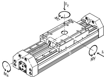
Wirken gleichzeitig mehrere der unten genannten Kräfte und Momente auf den Antrieb ein, müssen neben den aufgeführten Maximalbelastungen folgende Gleichungen erfüllt werden:
