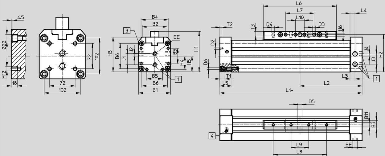
1 Einseitiger Druckluftanschluss, wahlweise an 3 Seiten an einem Abschlussdeckel (Variante D2: beidseitiger Druckluftanschluss, wahlweise an 3 Seiten pro Abschlussdeckel)
