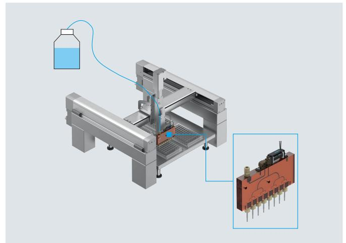
Das Verfahren basiert auf wenigen Parametern: Mit dem Druck im Behälter, dem Nadelquerschnitt und der Öffnungszeit des Ventils definieren Sie in Abhängigkeit von der verwendeten Flüssigkeit, wieviel Volumen in die Gefäße der Mikrotiterplatten gelangt.
