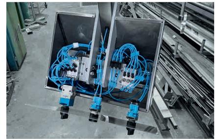
Aufgabe aufgrund seiner pneumatischen Endlagensignale und integrierten Stoßdämpfer. Ein weiterer Pluspunkt ist sein kompaktes und leichtes Design. Gesteuert wird er von robusten und langlebigen Pneumatikventilen VUVG.
