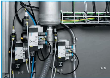
**Platzsparend:** automatisierte Kugelhahneinheiten, bestehend aus Kugelhähnen, Schwenkantrieben DFPD, Vorsteuerventilen VSNC und Endschalteinbauten SRBG.
