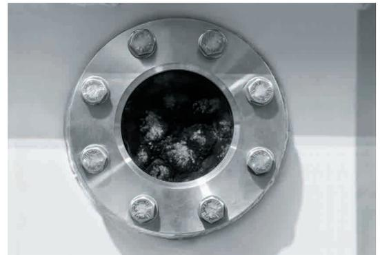
**Faserbälle gegen Mikroschadstoffe:** Fuzzy Filter Balls bestehen aus synthetischen Fasern in Form einer Kugel von etwa 33 mm Durchmesser. (Bild oben)
