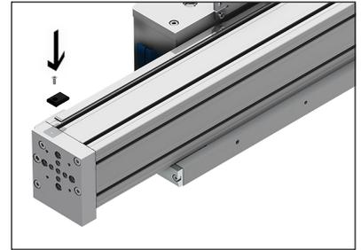
17. Sensorbefestigung mit der Messeinheit gemäß „Bedienungsanleitung Wegmess-System ELCC-...-M1“ an Endplatte montieren (→ Kapitel 1.1 auf Seite 6, → [www.festo.com](http://www.festo.com)).
