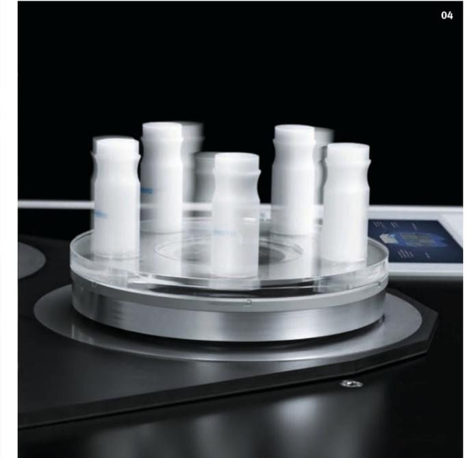
Supraleitende Automatisierungsmodule können mit einer Vielzahl von aktiven Antrieben realisiert werden. Das ermöglicht es ihnen, selbst ausgefallene Bewegungsabläufe, Lagerungsformen und Handhabungen schwebend auszuführen.
