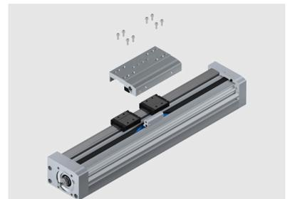
6. Gewindestifte der Abdeckbandklemmung so weit herausdrehen, dass diese mit dem Lagerbock / Lagerdeckel bündig sind.
