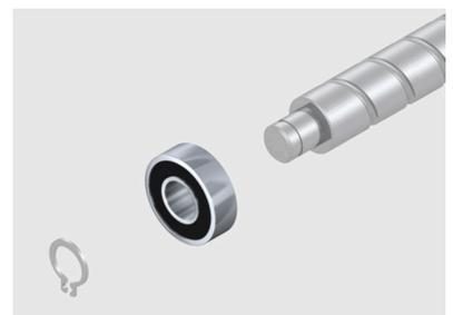
12. Wälzlager am Innenring mit einer dünnen Fettschicht versehen.
