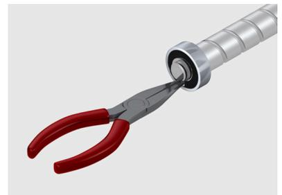
4. Wälzlager am Innenring mit einer dünnen Fettschicht versehen.
