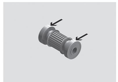
7. Sicherungsringe rechts und links einsetzen.
