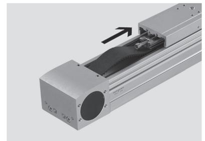
8. Klemmkörper in den Schlitten einführen.
