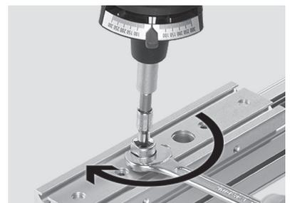
7. Starren Sechskantschlüssel in den Exzenter stecken und diesen in seiner Position halten.
