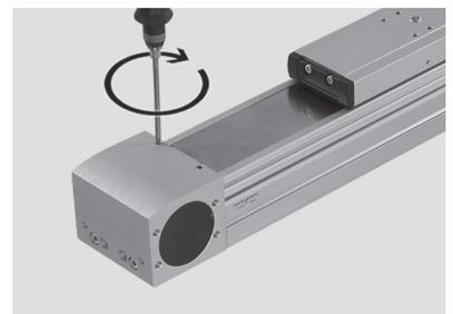
6. Gewindestifte leicht in den linken Antriebsdeckel eindrehen. Das Abdeckband darf dabei nicht fixiert werden.
