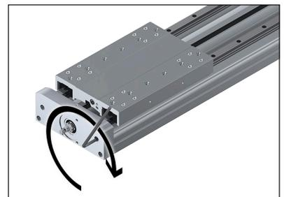
35. Schlitten nach vorne gegen die geschliffene Fläche der Wälzkassetten drücken und Zylinderschrauben mit dem entsprechenden Anziehdrehmoment festziehen.
