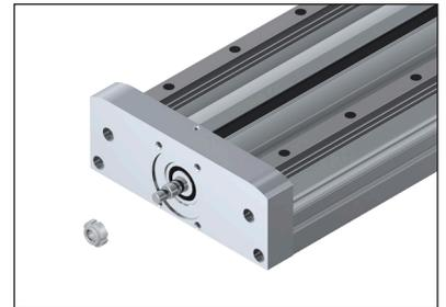
12. Zylinderschrauben aus Lagerbock herausdrehen.
