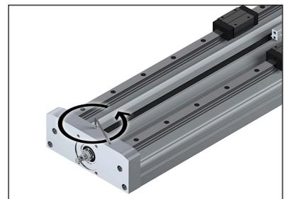
8. Zylinderschrauben aus Lagerdeckel herausdrehen.
