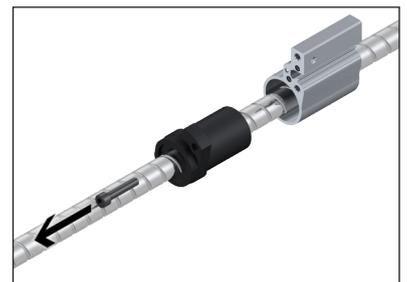
5. Halterbaugruppe auf Kugelgewindetrieb aufschieben.
