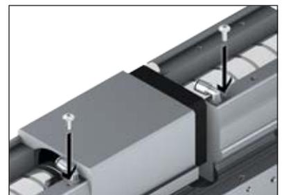
12. Befestigungsbohrungen für die Wälzswagen in der Schlitten-Baugruppe mit Schraubensicherungsmittel benetzen.
