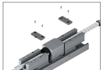
8. Schmierkanäle mit je zwei O-Ringen aus den Schmierklötzen bzw. aus den Wälzrädern ziehen.
