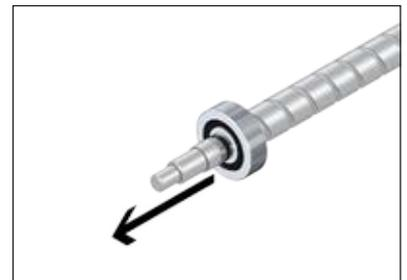
3. Neues Wälzlager am Innenring mit einer dünnen Fettschicht versehen.
