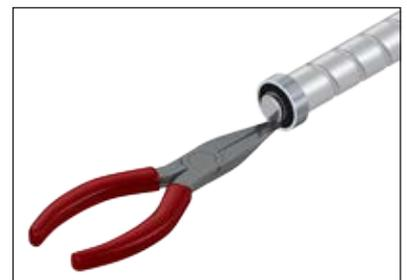
4. Rillenkugellager am Innenring mit einer dünnen Fettschicht versehen.
