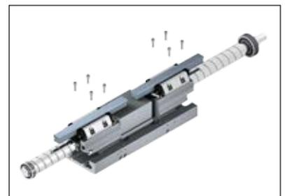
16. Wälzswagen mit der geschliffenen Seite an die Anschlagkante der Schlitten-Baugruppe drücken und gleichzeitig die Zylinderschrauben mit dem entsprechenden Anziehdrehmoment festziehen.
