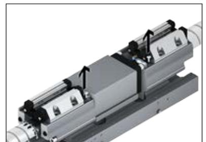
4. Cartridges aus den Bohrungen ziehen.
