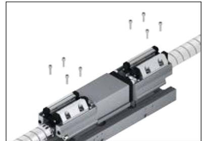
3. Die Bundschrauben an den beiden L-Stecknippel-Verschraubungen der Schmierung herausdrehen.
