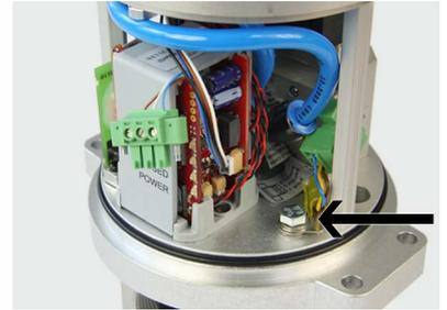
10. Pneumatikleitung aus der Winkel-Steckverschraubung im Zwischendeckel herausziehen, dabei blauen Ring nach hinten drücken und Pneumatikleitung abziehen.
