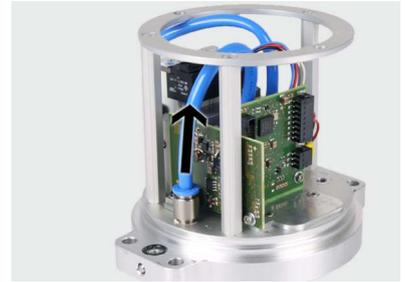
3. Beide Befestigungsschrauben aus dem Ventilblock herausdrehen und Ventilblock entnehmen.
