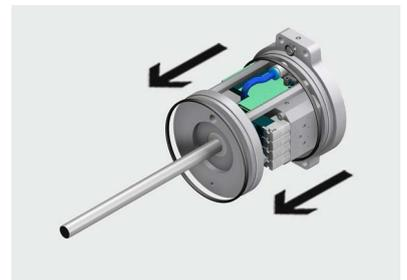
6. Beide O-Ringe der Abschlussdeckel-Baugruppe leicht mit Fett benetzen.
