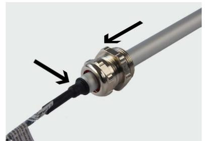
7. Neues Wegmesssystem in Zwischenplatte einsetzen.
