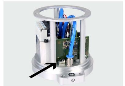
6. Ventilkabelkonfektion analog den Beschriftungen Y1, Y2, Y3 und Y4 in Ventilblock einstecken.
