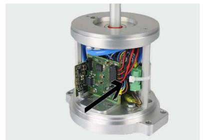
7. Sechskantschraube des Erdungsanschlusses herausdrehen.
