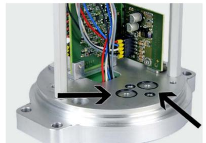
7. Neuen Ventilblock so einsetzen, dass die Fasen nach außen zeigen.
