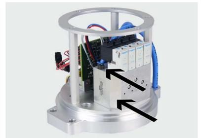
9. Ventilkabelkonfektion analog den Beschriftungen Y1, Y2, Y3 und Y4 in Ventilblock einstecken.
