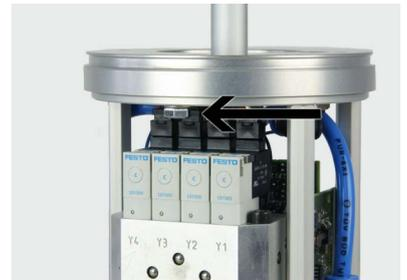
4. Pneumatikleitung aus Steueranschluss 4 des Ventilblocks in Steckverbindung im Zwischendeckel einstecken. Pneumatikleitung über den Regler in einem Bogen vorbeiführen.
