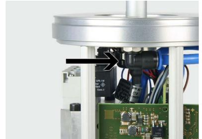
3. Beide Befestigungsschrauben des Zwischendeckels leicht mit LOCTITE 243 benetzen und mit dem entsprechenden Anziehdrehmoment festziehen.
