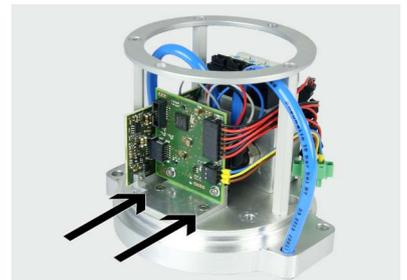
3. Befestigungsschraube des Haltewinkels herausdrehen.
