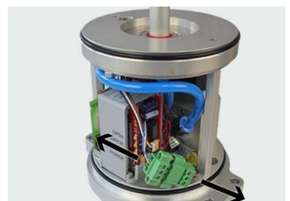
9. Sechskantschraube des Erdungsanschlusses herausdrehen.
