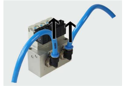
5. Neue Pneumatikleitungen in Steckverbindungen im Ventilblock einstecken.
