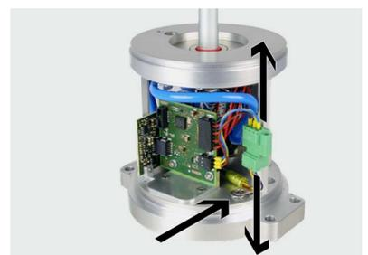
10. Pneumtikleitung aus der Winkelverschraubung im Zwischendeckel herausziehen, dabei blauen Ring nach hinten drücken und Pneumatikleitung abziehen.
