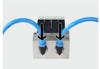
6. Alle vier O-Ringe zur Dichtung der Druckluft zwischen Ventilblock und Abschlussdeckel leicht mit Fett benetzen und in Abschlussdeckel einsetzen.
