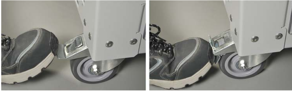
Abbildung 9: Arretieren der Schwenkrollen der optionalen Werkbank
