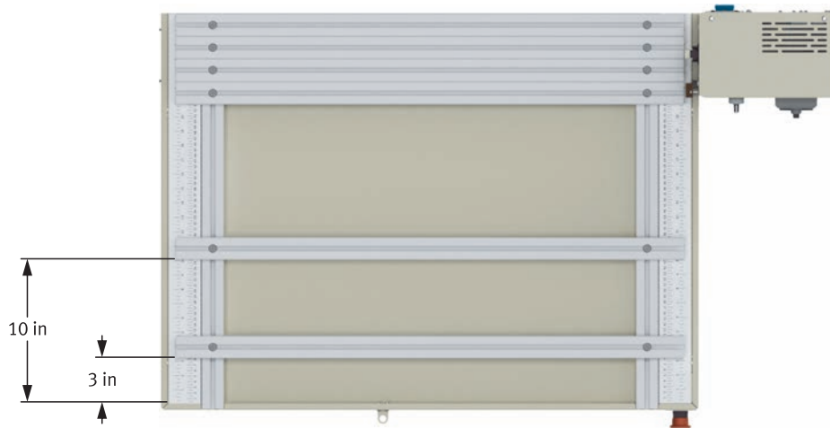
Figura 11: Montaje del Puesto de trabajo.
