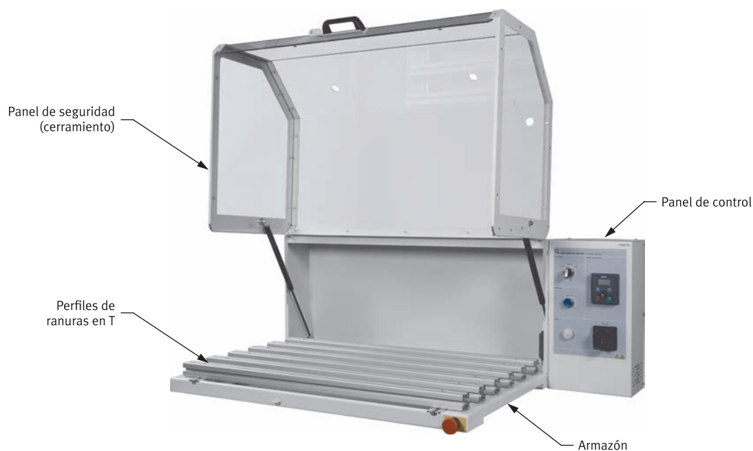
Figura 1: Puesto de trabajo del Sistema didáctico en accionamientos mecánicos.
