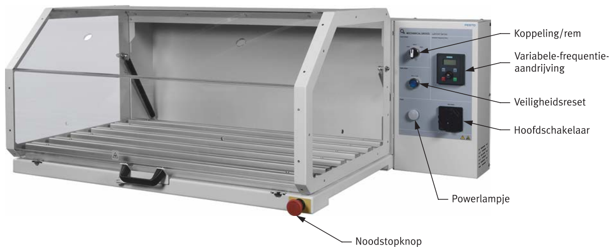
Afbeelding 2: De besturingselementen van het werkstation.
