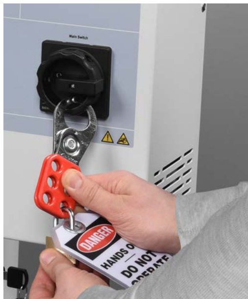
Afbeelding 8: Installatie van een lockout-beugel, hangslot en tag.
