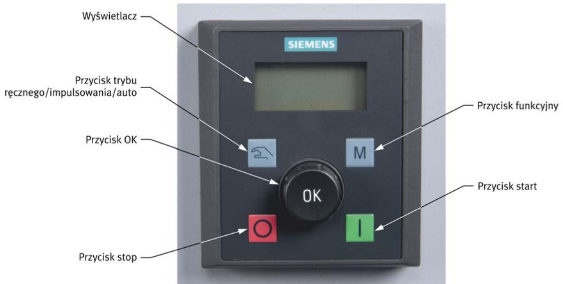
Rysunek 6: Układ panelu napędu o zmiennej częstotliwości.
