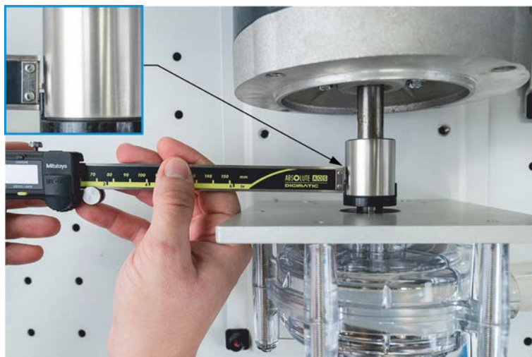
Figura 15: Mida la protuberancia de la espiga en las posiciones verticales y horizontales (aquí, con un calibrador digital).
