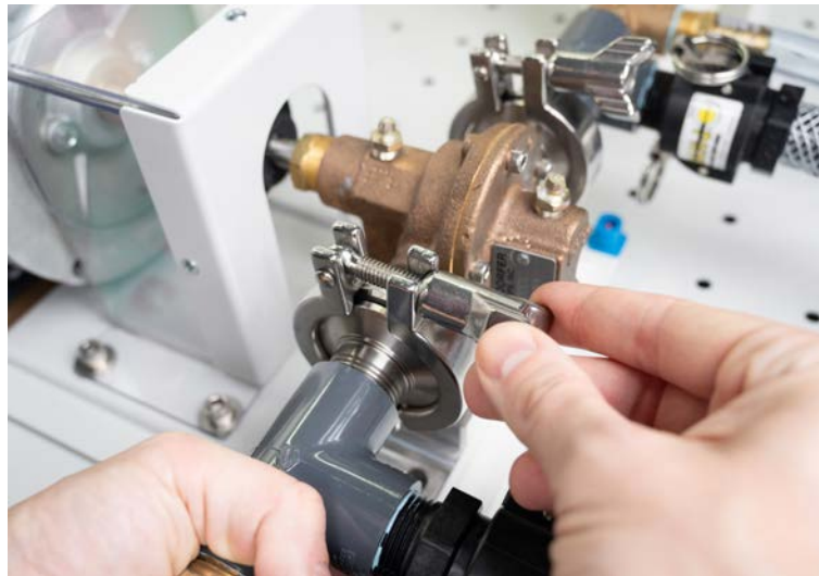
Figura 47: Bloqueo de los accesorios con la tuerca de mariposa.
