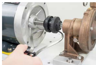
Figura 12: Medición de la desalineación angular – Abajo.
