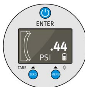
Figura 18: Interfaz del medidor de presión.
