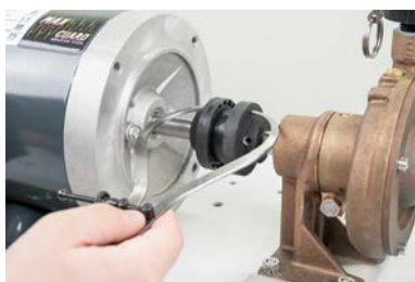
Figura 11: Medición de la desalineación angular – Arriba.
