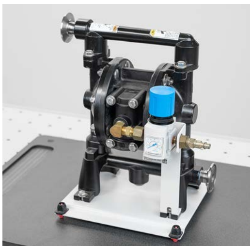
Figura 52: Bomba neumática de membrana en la superficie de trabajo (delante).
