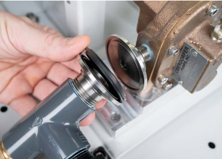
Figura 45: Prensado de los accesorios, con la junta en el medio.
