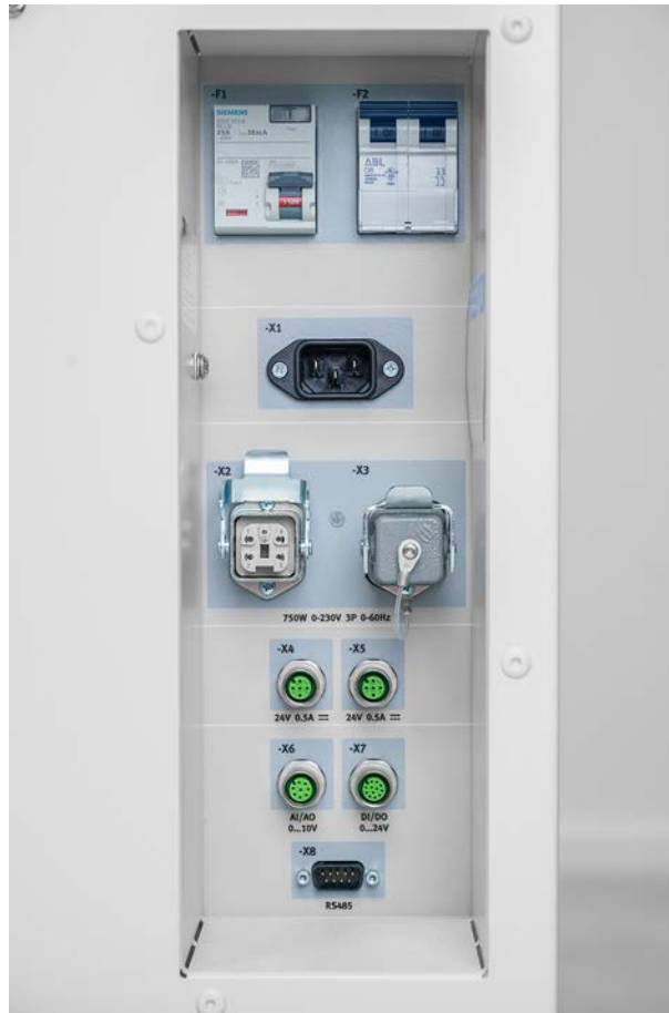
Figura 28: Panel de conexión en la parte posterior del banco de sistemas.
