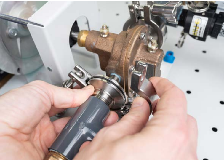
Figura 46: Colocación del accesorio de apriete en ambos accesorios y cerrarlo.
