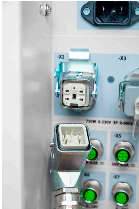
Figura 29: Conexión al conector del motor.
