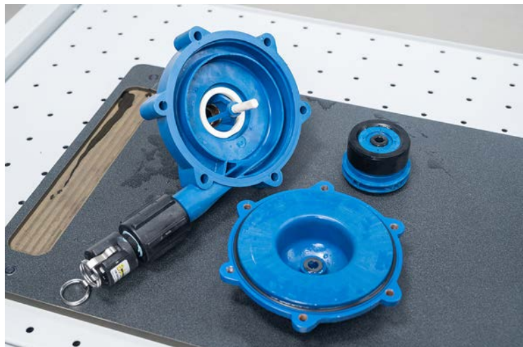
Figura 64: Componentes internos de la bomba centrífuga de accionamiento magnético.
