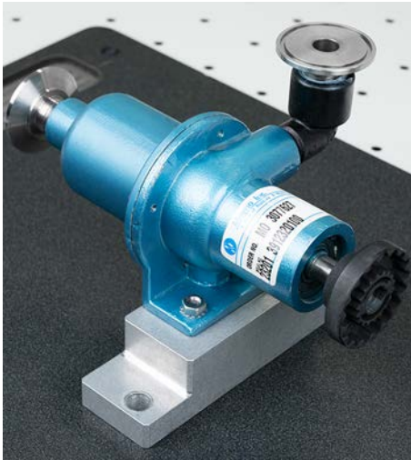
Figura 50: Bomba de cavidad progresiva en la superficie de trabajo.
