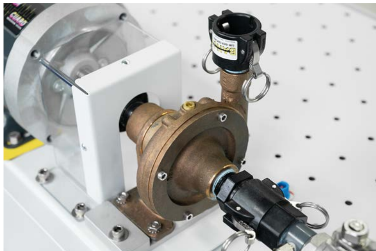
Figura 9: Tapón de latón utilizado para cebar la bomba.
