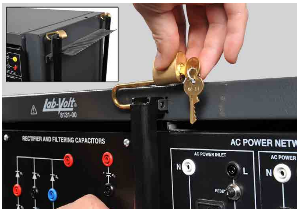
Figure 20 : Deux barres de sécurité doivent être cadenassées à l'avant du poste de travail pour empêcher les étudiants de retirer les modules EMS pendant les exercices de laboratoire. Les barres peuvent être retirées et cadenassées sur le côté du poste de travail lorsque le verrou de sécurité n'est pas nécessaire.
