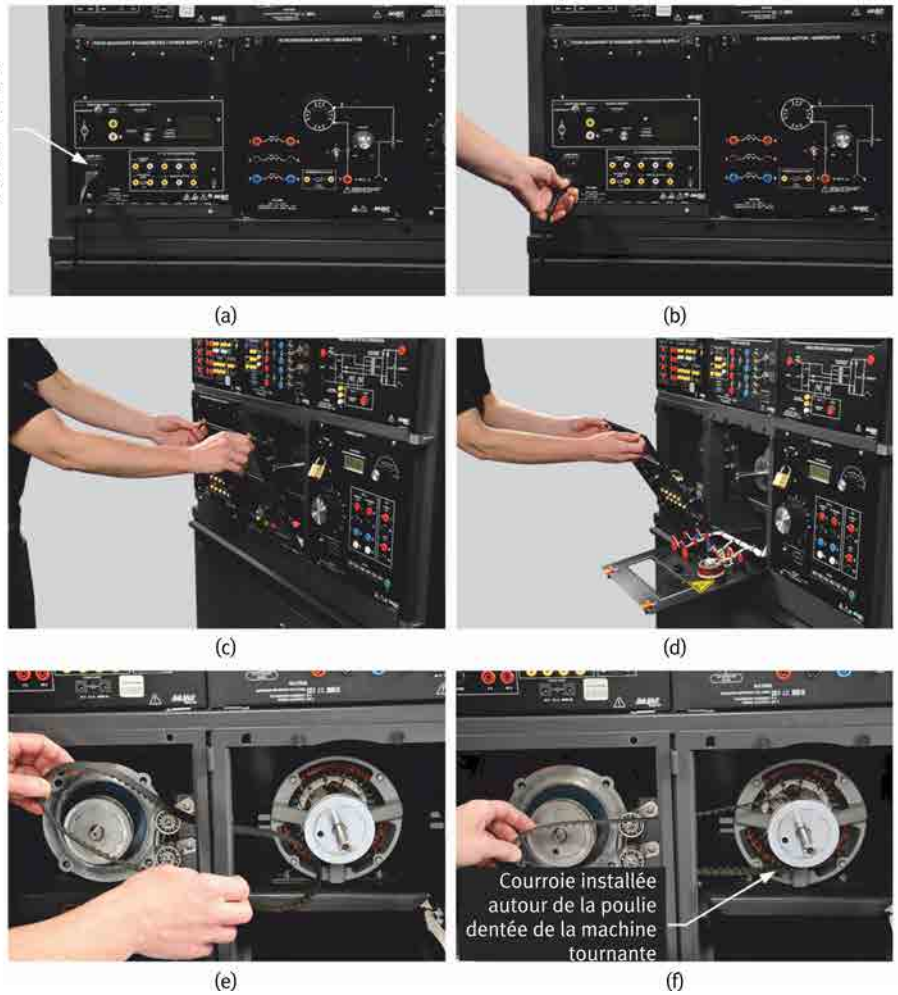
Figure 29: Couplage mécanique d'un Dynamomètre/Bloc d'alimentation à quatre quadrants, modèle 8960, à une machine tournante EMS (partie 1).
