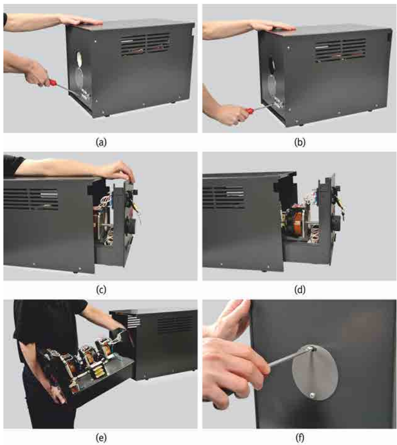
Figure 40 : Retrait d'un Bloc d'alimentation du Poste de travail, modèle 8133.
