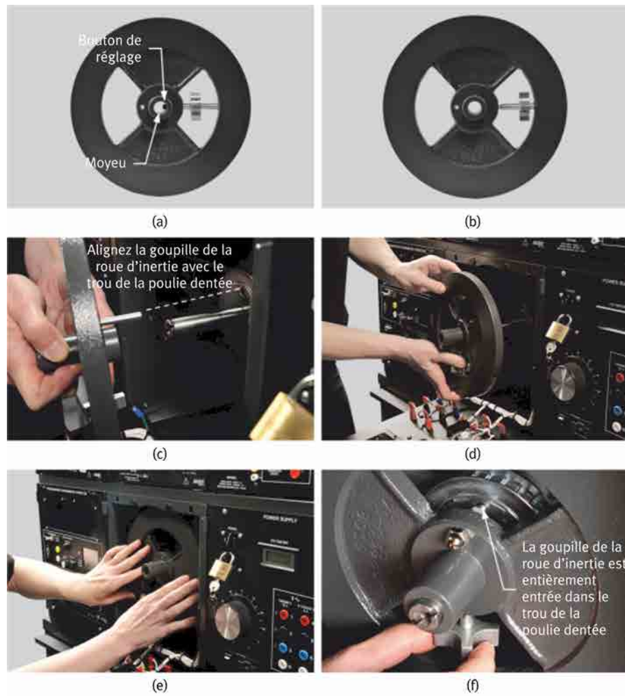
Figure 27 : Installation d'une roue d'inertie sur l'arbre d'une machine tournante EMS.
