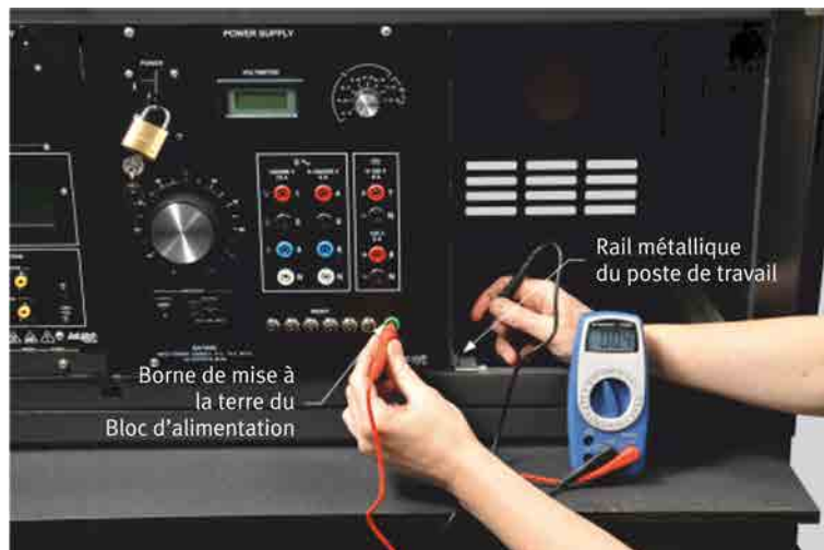
Figure 33 : Vérification de la connexion de la borne de mise à la terre du Bloc d'alimentation avec un ohmmètre.
