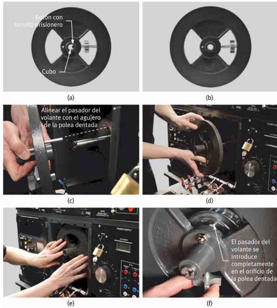
Figura 27: Instalación de un volante de inercia en el eje de una máquina rotativa EMS.
