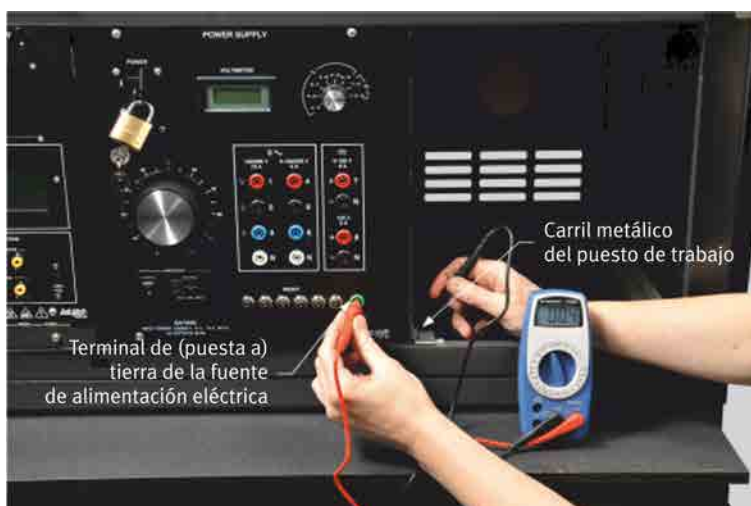
Figura 33: Verificación de la conexión del terminal de tierra de la fuente de alimentación con un óhmetro.
