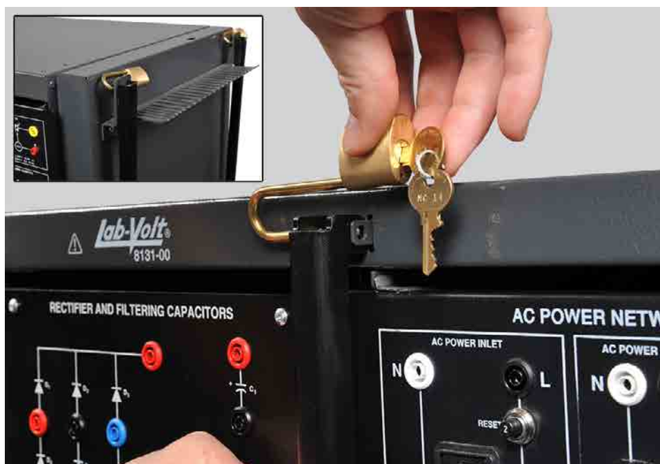
Figura 20: Deben colocarse dos barras de seguridad con candado en la parte delantera del puesto de trabajo para evitar que los estudiantes retiren los módulos EMS durante los ejercicios de laboratorio. Las barras pueden retirarse y fijarse con candado al costado del puesto de trabajo cuando no sea necesario el bloqueo de seguridad.
