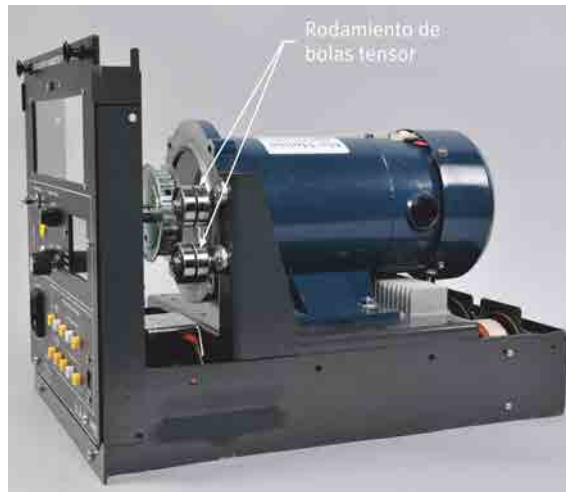
Figura 41: Los rodamientos de bolas tensores de las máquinas rotativas EMS precisan lubricación periódica.
