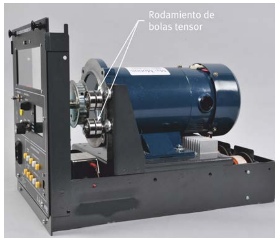
Figura 68: Los rodamientos de bolas tensores de la polea loca de las máquinas rotativas EMS requieren lubricación periódica.
