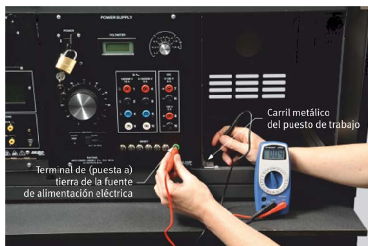
Figura 32: Verificación de la conexión del terminal de tierra de la fuente de alimentación con un óhmetro.
