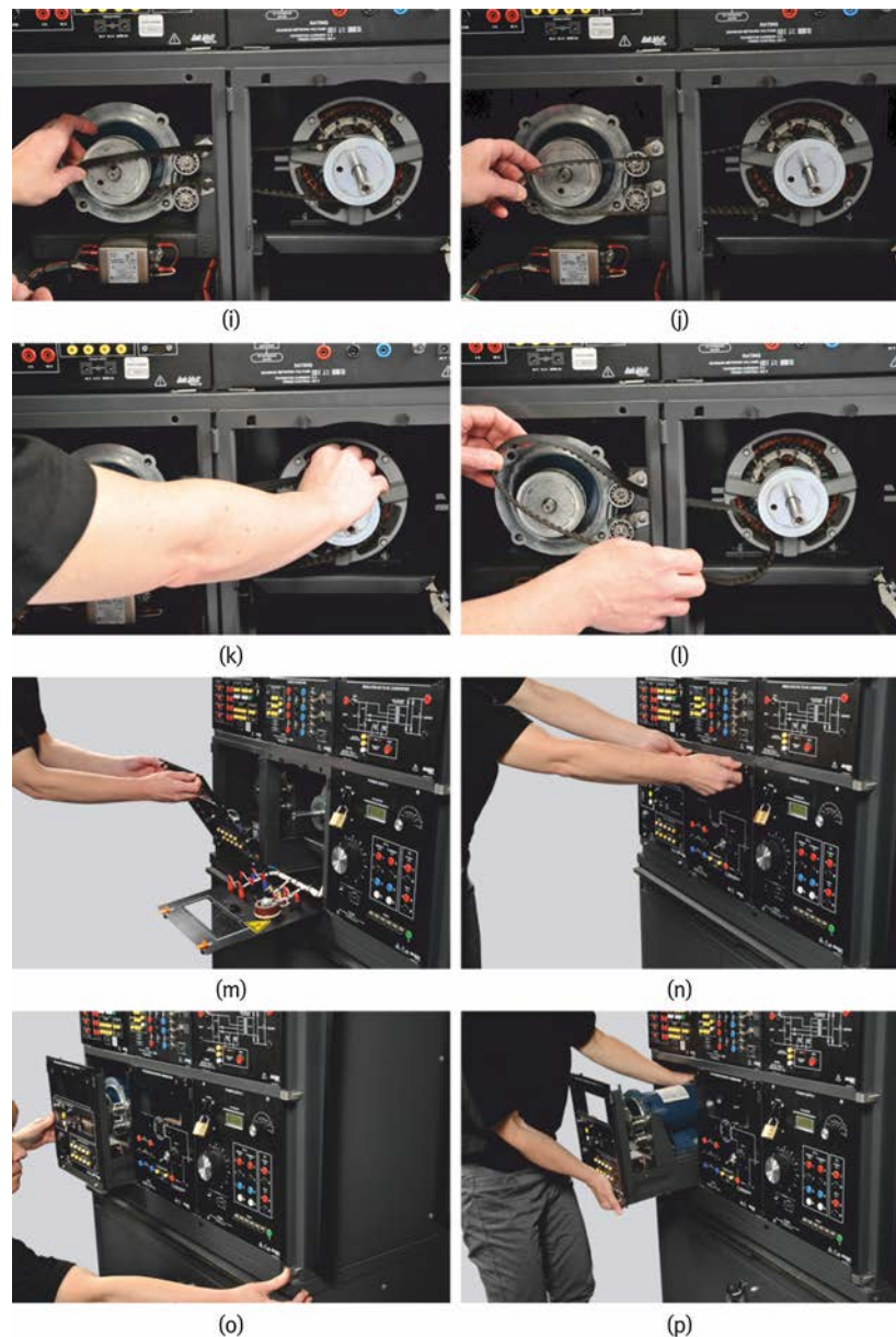
Figura 37: Extracción de una máquina rotativa EMS acoplada al Dinamómetro/Fuente de alimentación de cuatro cuadrantes, modelo 8960, de un compartimento de altura completa de un puesto de trabajo (parte 2).
