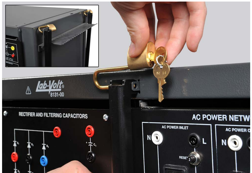
Figura 19: Deben colocarse dos barras de seguridad con candado en la parte delantera del puesto de trabajo para evitar que los estudiantes retiren los módulos EMS durante los ejercicios de laboratorio. Las barras pueden retirarse y fijarse con candado al costado del puesto de trabajo cuando no sea necesario el bloqueo de seguridad.
