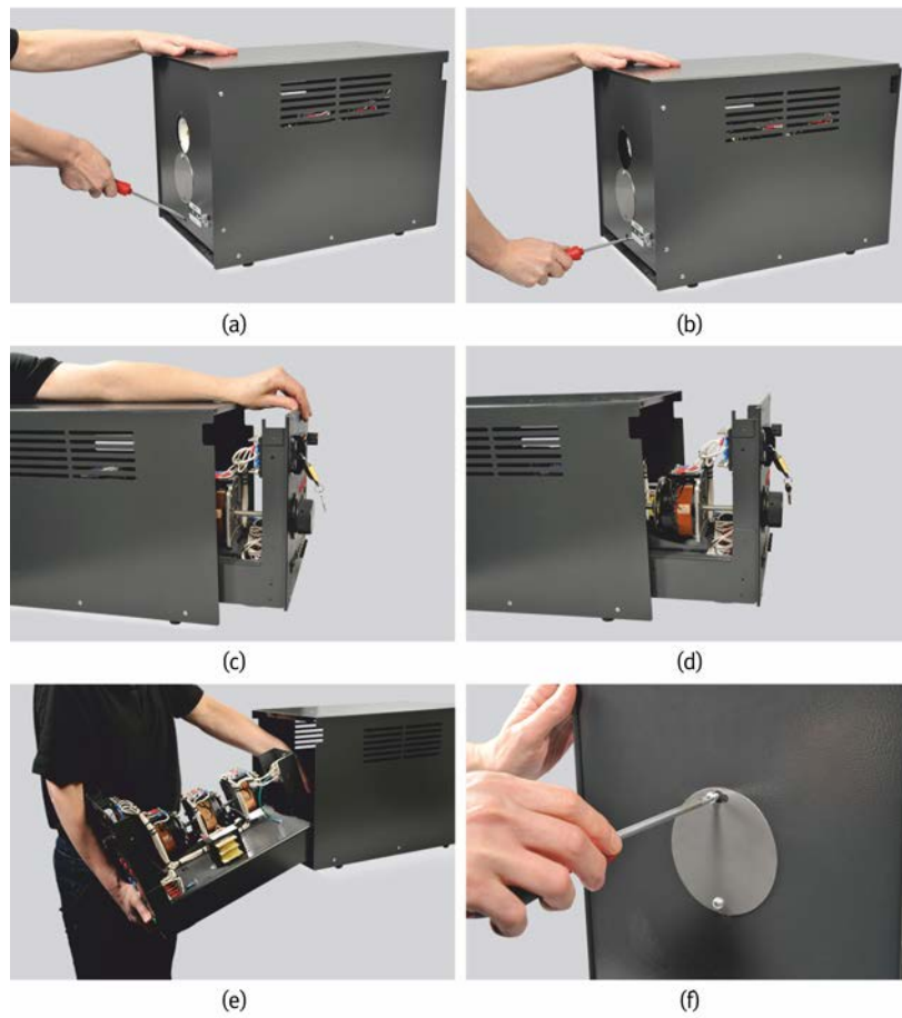
Figura 39: Extracción de una fuente de alimentación del Puesto de trabajo, modelo 8133.
