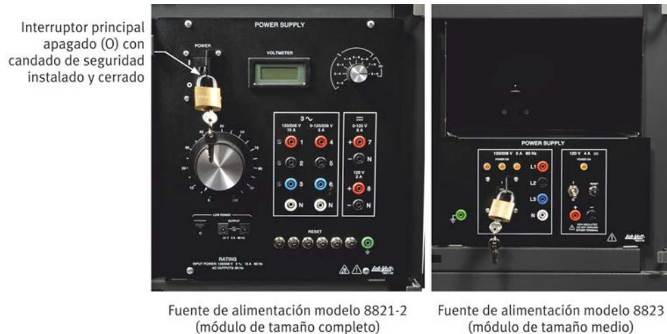
Figura 31: En la fuente de alimentación, asegúrese de que el interruptor principal esté en la posición 0 (apagado). Asegúrese también de que el candado de seguridad del interruptor principal esté instalado y bloqueado.
