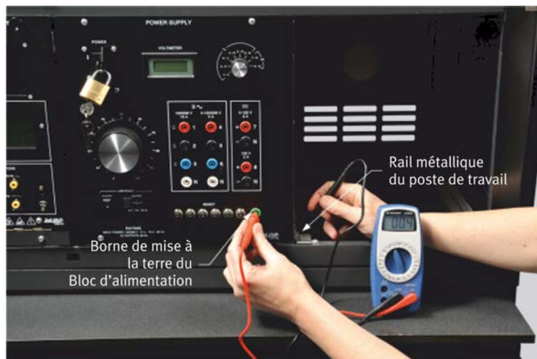
Figure 32 : Vérification de la connexion de la borne de mise à la terre du Bloc d'alimentation avec un ohmmètre.
