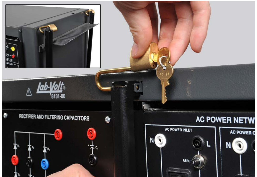
Figure 19 : Deux barres de sécurité doivent être cadenassées à l'avant du poste de travail pour empêcher les étudiants de retirer les modules EMS pendant les exercices de laboratoire. Les barres peuvent être retirées et cadenassées sur le côté du poste de travail lorsque le verrou de sécurité n'est pas nécessaire.
