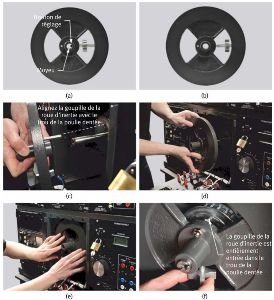
Figure 26 : Installation d'une roue d'inertie sur l'arbre d'une machine tournante EMS.
