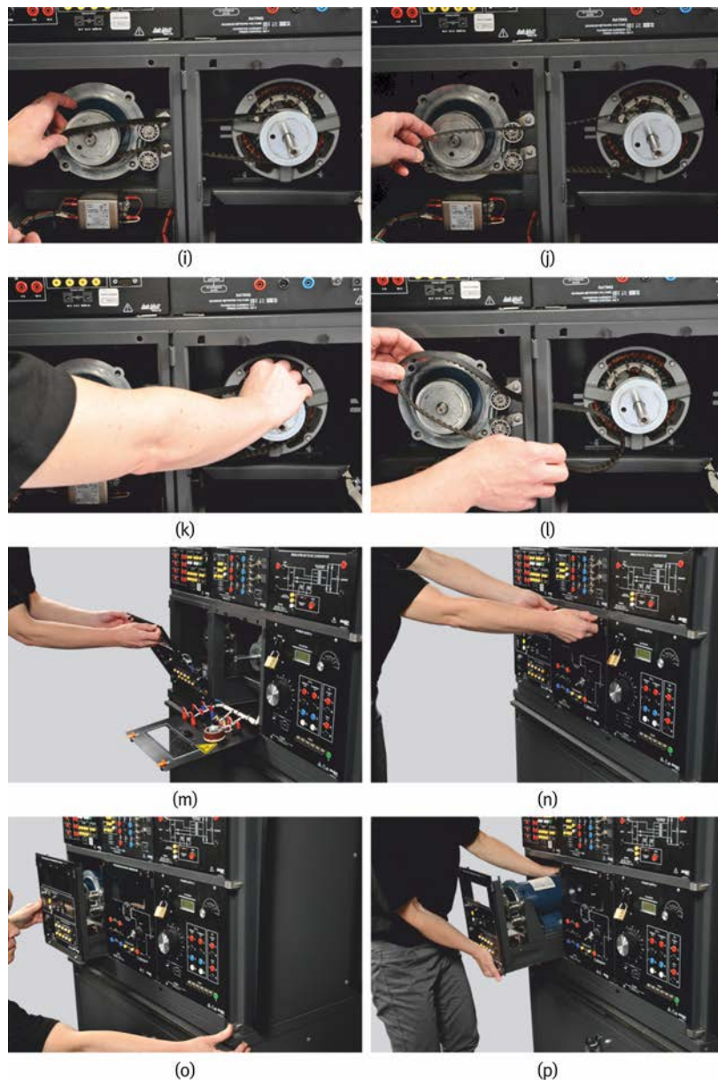
Figure 37 : Retrait d'une machine tournante EMS couplée au Dynamomètre/Bloc d'alimentation à quatre quadrants, modèle 8960, d'un compartiment pleine hauteur d'un poste de travail (partie 2).
