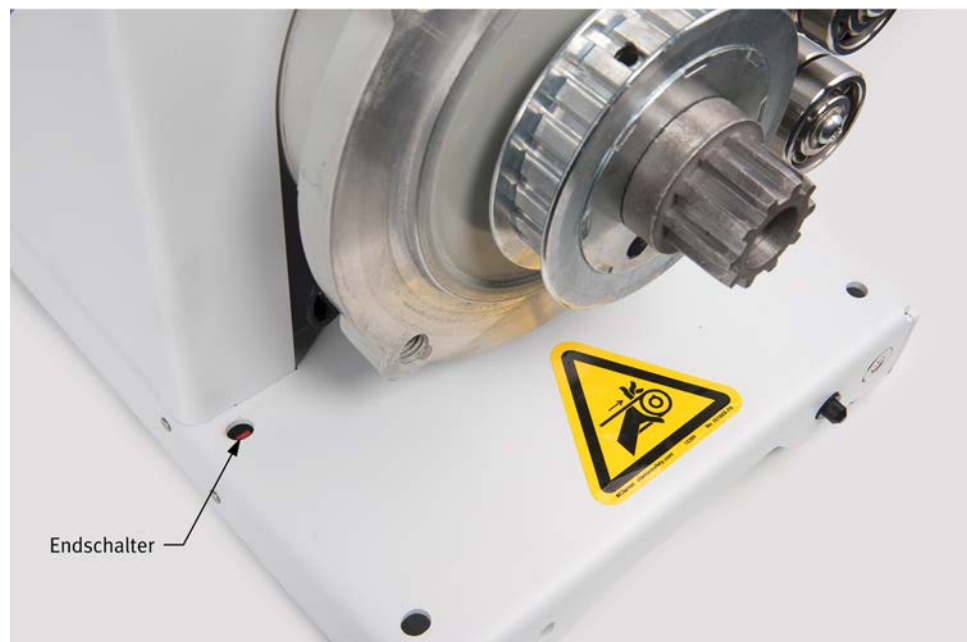
Abbildung 18: Ein Endschalter in der Grundplatte jeder rotierenden Maschine verhindert den Betrieb der Maschinen, solange keine Schutzvorrichtung ordnungsgemäß installiert ist.
