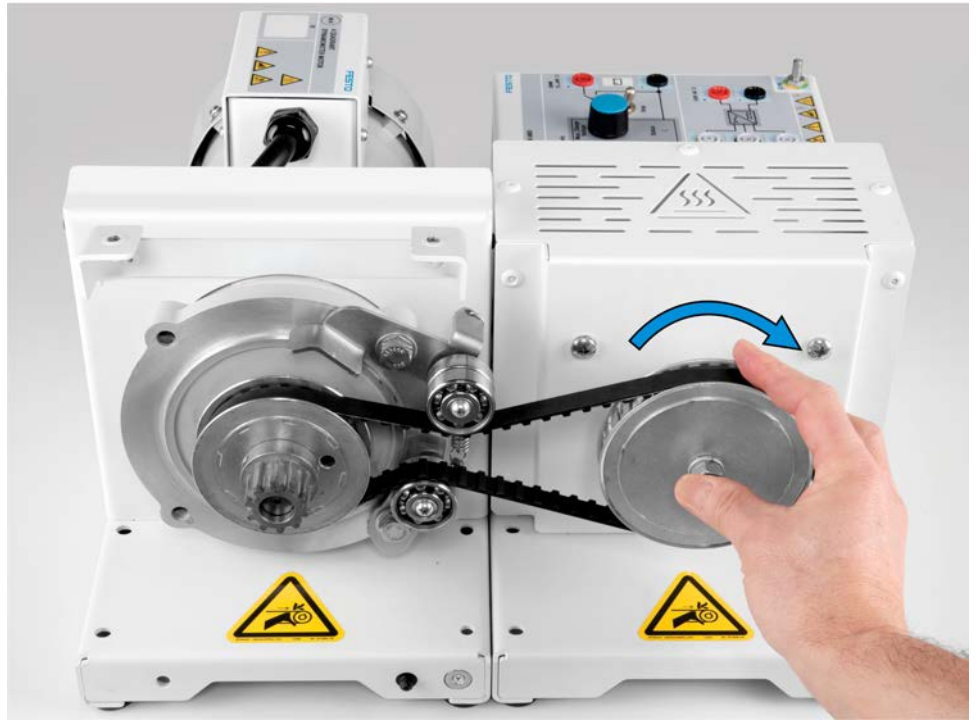
Abbildung 9: Um sicherzustellen, dass der Zahnriemen korrekt installiert ist, drehen Sie die Welle der Antriebsmaschine oder der rotierenden Maschine von Hand. Beide Maschinen sollten sich dabei drehen und der Zahnriemen sollte von beiden Lagern des Riemenspanners gespannt werden.
