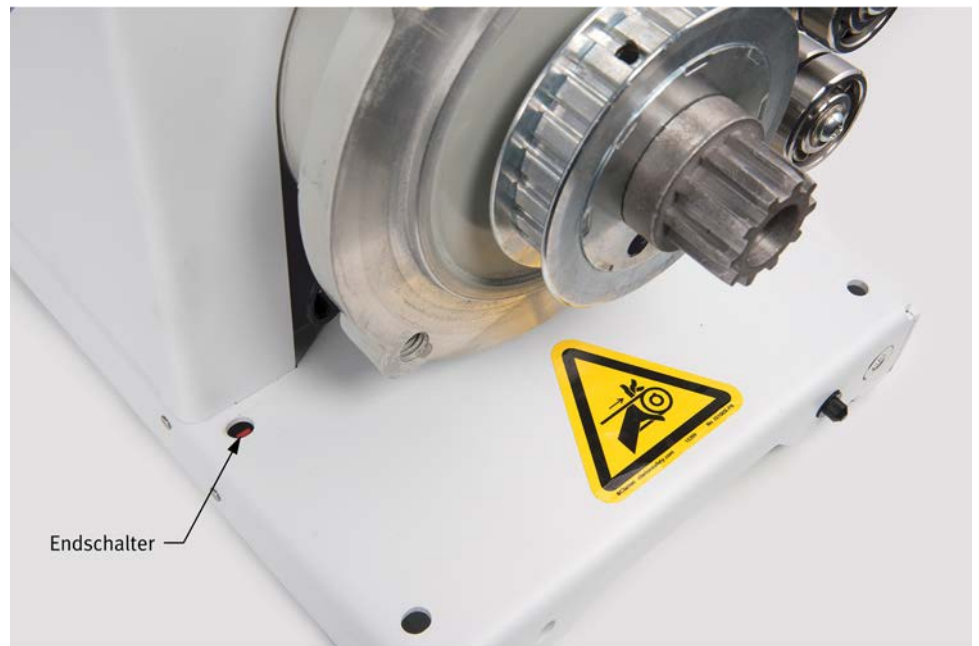
Abbildung 15: Ein Endschalter in der Grundplatte jeder rotierenden Maschine verhindert den Betrieb der Maschinen, solange keine Schutzvorrichtung ordnungsgemäß installiert ist.
